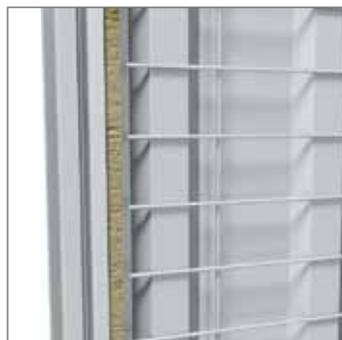
Situada debajo de la lámina de enrase del yeso contribuye a proporcionar una buena rigidez a la estructura frontal y evita la formación de grietas en el yeso.
