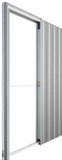
Módulos en acero galvanizado combinables con encaje. Entramado metálico fino. Pestañas de anclaje de malla moldeadas y acanaladas. Cubierta superior moldeada y estructurada en una sola pieza. Guía de aluminio reforzado con guía de ensamblaje rápido. Distancial de alineación inferior. Junta elástica antigrietas. Perfiles de aluminio para enrasar el yeso. Distanciales de alineación reforzados. Juegos de roldanas de hasta 160 Kg.
