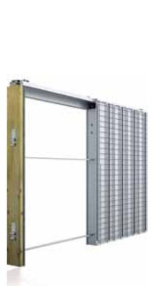
Módulos en acero galvanizado combinables con encaje. Entramado metálico fino. Pestañas de anclaje de malla moldeadas y acanaladas. Cubierta superior moldeada y estructurada en una sola pieza. Guías de aluminio reforzado con guía de ensamblaje rápido. Perfiles de aluminio para enrasar el yeso. Guía en acero galvanizado. Distancial de alineación reforzada. Junta elástica antigrietas. Placas de aislamiento laterales (sólo bajo petición). Juegos de roldanas de hasta 160 Kg.
