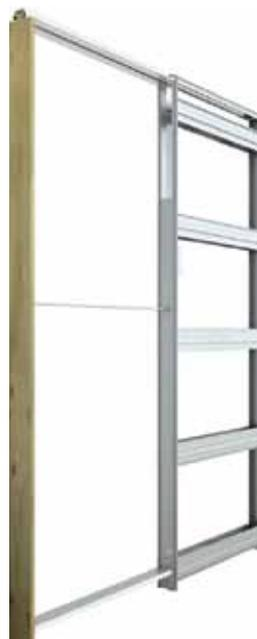
Perfiles en acero galvanizado moldeado. Distanciales horizontales con cierre automático. Cubierta superior moldeada y estructurada en una sola pieza. Guías de aluminio reforzado con guía de ensamblaje rápido. Perfil que sostiene la placa de cobertura. Guía en acero galvanizado. Distancial de alineación inferior. Juegos de roldanas de hasta 160 Kg. Disponible en dos versiones: kit para montar o armazón ya montado.
